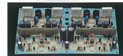
信号系路を最短距離にレイアウトしたシンメトリカルな新開発ディスパーシャル基板。
