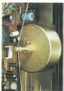
精度の高いメタリックベアスダイアルスケールは、実効長200mmのロングスケールですから、正確度の高いチューニングが可能で、チューニング機構はハイクラスなチューナーと同様に慣性性能の高い大型フライホイールを採用し、実
