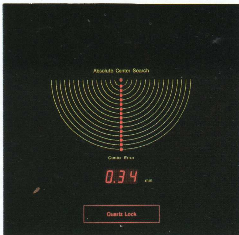
センターサーチ中のディスプレイ。センターエラーが0.34ミリであることを示しています。
