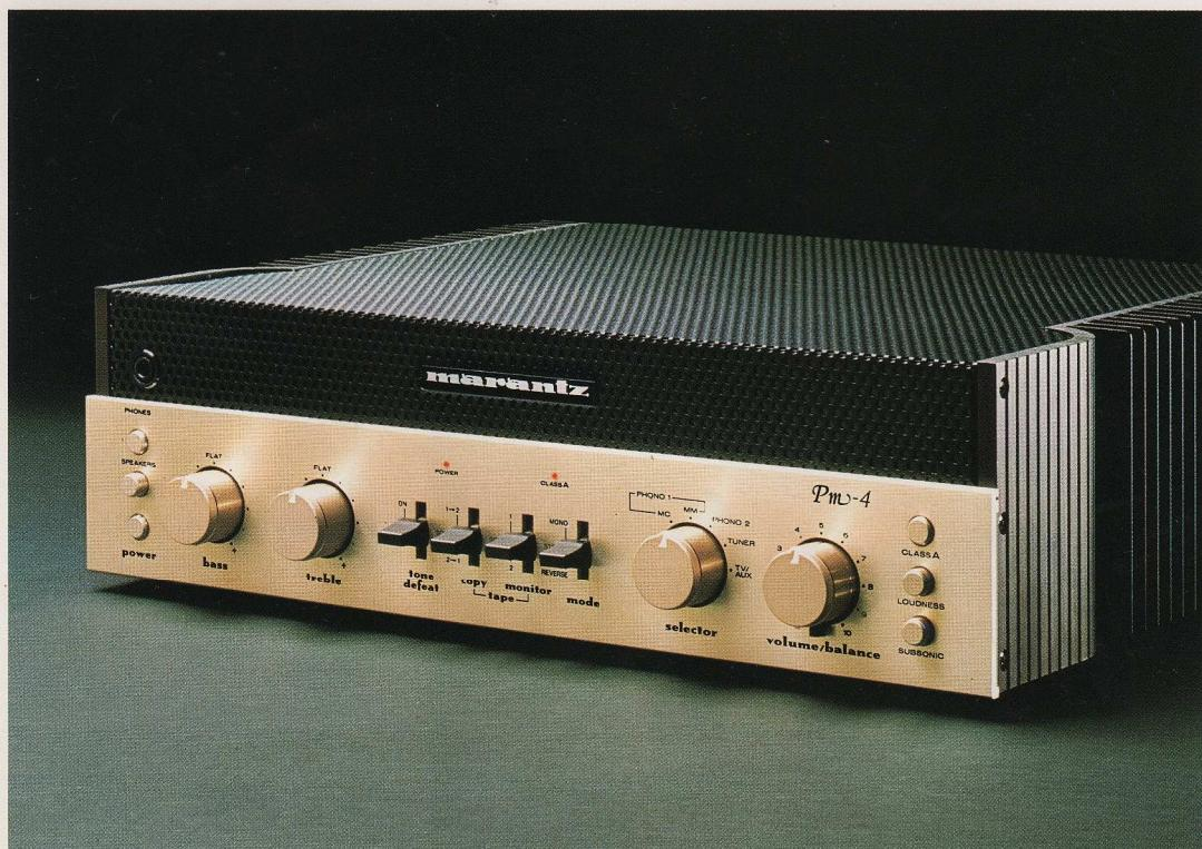
Pm-4は、没個性的な製品が氾濫する中にあって、まずその独特なスタイリングで、本物を見極める眼を持った人に強くアピールするプリメインアンプ。しかもその内容の高さは、このアンプの個性に寄せられる期待を裏切りません。MCカートリッジをダイレクトに接続できる超ローノイズ・ハイゲインのフォノアンプ、優れた音質を変えることなく低域と高域をそれぞれ±10dB可変しながら、必要な場合はスイッチ1つで瞬時にディフィートできるトーンコントロールアンプ、90MHzまでの超高域特性を持つスーパー・ハイ・ゲイン・パワートランジスターの採用により、過渡的な歪を駆除し、デザインの面でも大きな特徴となっているボディ両サイドに配した外付けヒートシンクによって、AB級60W+60W/A級15W+15Wのパワーを余裕をもって生みだすメインアンプ。しかも上級機Pm-5ゆずりの音質最優先Low-TIM設計を全段に貫いて、音楽をリアルに生き生きと再現します。この内容の高さとユニークなスタイリングが、確かな個性を主張するプリメインアンプです。
