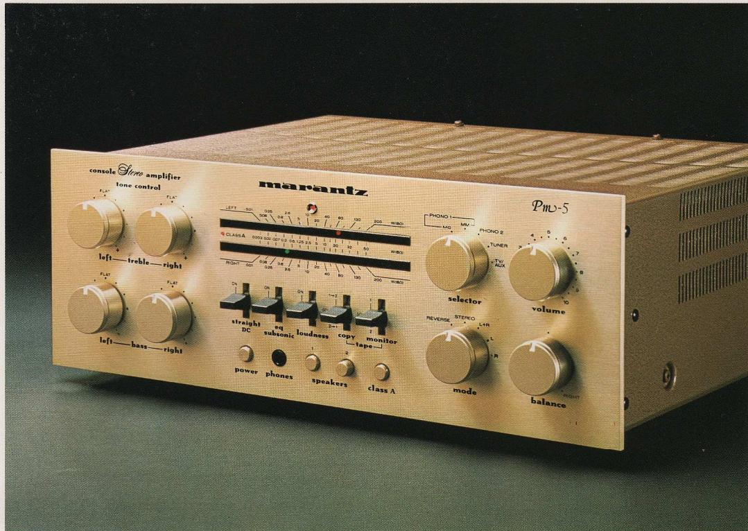
Pm-5は、入力から出力まで、独自のLow-TIM設計による全段完全プッシュプルDC回路構成を実現したプリメインアンプ。超ローノイズトランジスター14石による本格的なMCヘッドアンプ、初段にプッシュプル接続の超ローノイズFETを、イコライザー素子に誤差1%級金属皮膜抵抗・2%級ポリプロピレンコンデンサーを投入した精密なフォノアンプ、DCサーボ回路内蔵・スーパー・ハイ・ゲイン・パワートランジスターによるAB級80W+80W/A級20W+20Wのメインアンプと、それぞれのユニットアンプが高度なセパレートアンプクラスのグレードを達成しながら、フォノアンプ出力をダイレクトにメインアンプへ結ぶことのできるストレートDC回路など、プリメインアンプタイプに一体化したメリットを最大限に生かして、純度の高い伝送能力を獲得しています。さらに、LEDピークパワーメーターをはじめ、多彩な機能をシムメトリカルに動かししようのない完璧さでフロントパネルにレイアウト。
