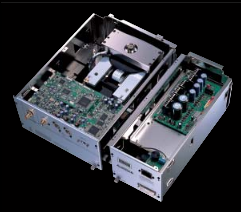
トランスポート部(左)と電源ユニット部(右)を完全分離するダブルブロック構造
