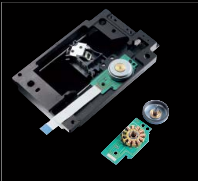
ピックアップ移動用にティアックオリジナルのホール素子検出型3相ブラシレスモーター(右)を搭載した速度帰還制御スレッド送り部分
