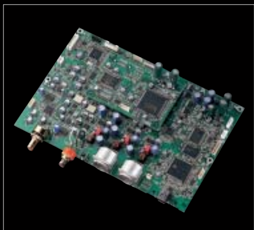
デジタルオーディオ出力基板とDSDコンバート基板(中央部)
