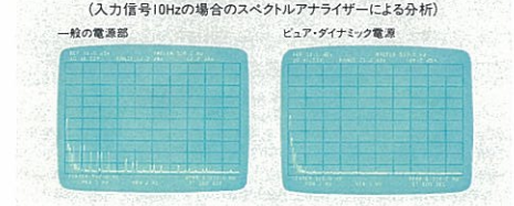
写真-3 ピュア・ダイナミック電源によるDIMUひずみ低減効果(入力信号10Hzの場合のスペクトルアナライザーによる分析)
