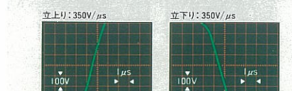
写真-1 PMA-960パワー部のスルーレイト(tuner → speaker)
