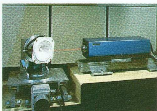
レーザーとコンピューターによる振動体解析試験。
