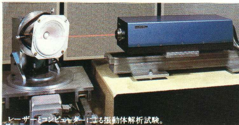
レーザー・インターフェロメーターによる振動体解析試験。
